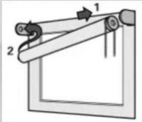
Primero inserte el rodillo en el soporte con el mecanismo de cadena / arganillo / motor y luego en el otro.
