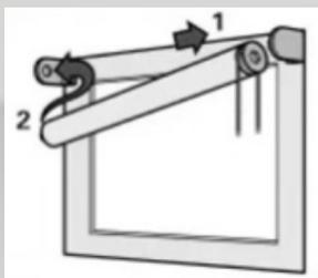
Insérez d'abord le rouleau dans le support avec le mécanisme de chaîne / arganello / moteur, puis dans l'autre.
